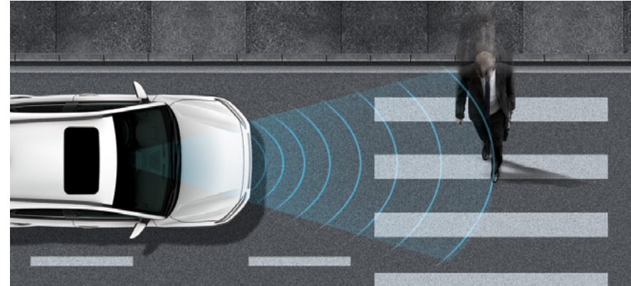
בלימה אוטונומית של הרכב במצבי חירום וזיהוי הולכי רגל עד 80 קמ"ש (AEB) שילוב של מצלמה ורדאר לזיהוי כלי רכב והולכי רגל, ועצירה אקטיבית של הרכב במצב חירום.
