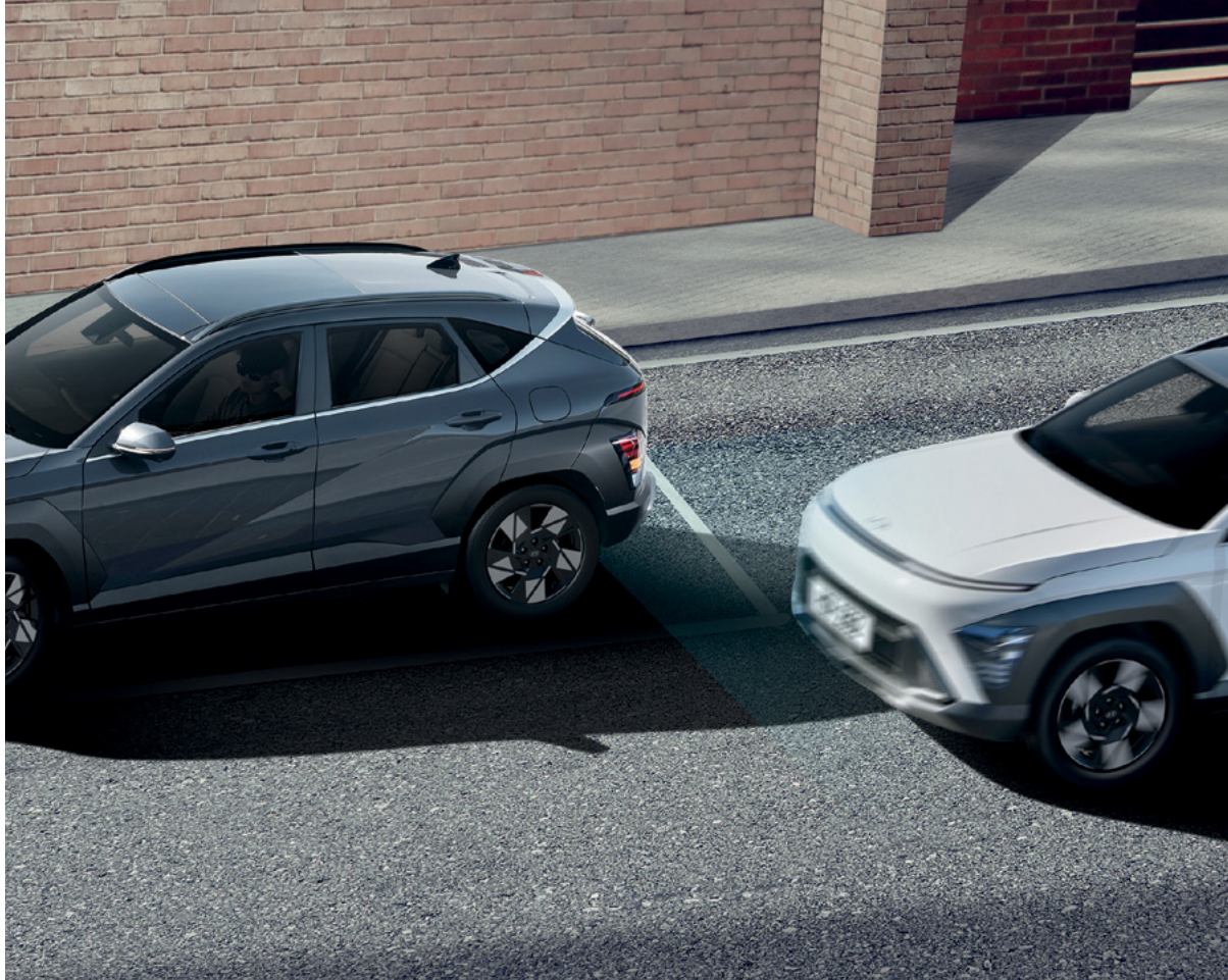
מערכת אקטיבית לזיהוי ומניעת התנגשות בכלי רכב ב"שטח מת" (BCA)* מערכת מבוססת רדאר המתריעה על רכבים ב"שטח מת" בעת מעבר נתיב ומבצעת תיקון הגה אוטומטי במידה והנתיב אינו כנוי.
