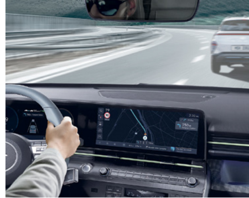
בקרת שיוט חכמה (SCC) שומרת על מהירות ומרחק קבועים מהרכב שמלפנים בעזרת חיישן רדאר ושולטת בהאצה והאטת הרכב באופן אוטונומי עד עצירה מוחלטת*.
