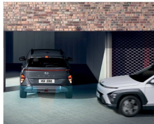
התרעה ומניעת פגיעה ברכב חוצה מאחור (RCCA)* מערכת אקטיבית למניעת פגיעה ברכב חוצה בעת נסיעה לאחור.
