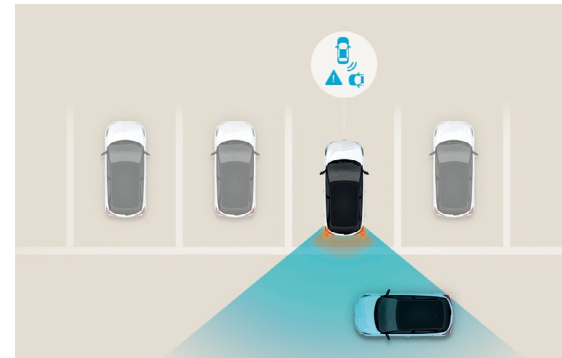
התרעה ומניעת פגיעה ברכב חוצה מאחור (RCCA)* מערכת אקטיבית להתרעה ומניעת פגיעה ברכב חוצה בעת נסיעה לאחור.
