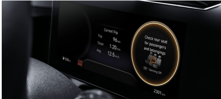
חיווי תזכורת למניעת שכחת נוסע במושב האחורי (ROA) מערכת ROA המתריעה על שכחת ילד/נוסע במושב האחורי.
