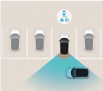
התרעה ומניעת פגיעה ברכב חוצה מאחור (RCCA) מערכת אקטיבית להתרעה ומניעת פגיעה ברכב חוצה בעת נסיעה לאחור.
